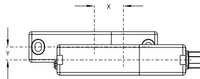
Versões com engate X  $\pm 5$  mm, Y  $\pm 3$  mm. Deslocamento reduz a força de retenção.
