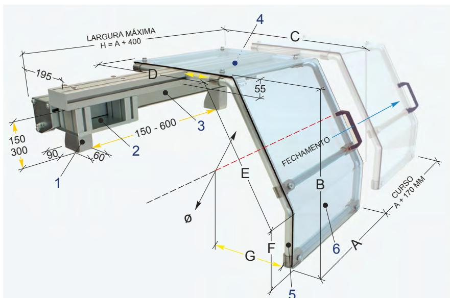
**1** Suportes de fixação com grande ajuste vertical
