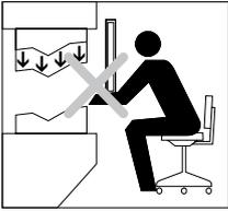
As partes perigosas da máquina podem ser alcançadas sem ter que atravessar o campo de proteção.
