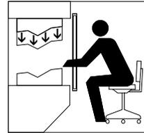
As partes perigosas da máquina podem ser alcançadas apenas atravessando o campo de proteção.
