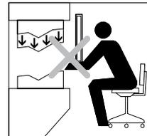
As partes perigosas da máquina podem ser alcançadas sem ter que atravessar o campo de proteção.
